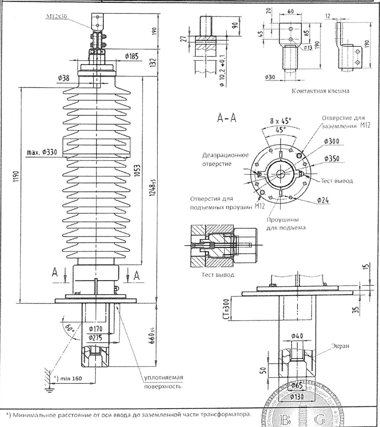
\*) Минимальное расстояние от оси ввода до заземленной части трансформатора.
