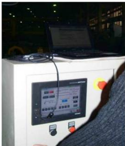
Рисунок 4. Пульт управления и электрошкаф установки для динамической стабилизации.
