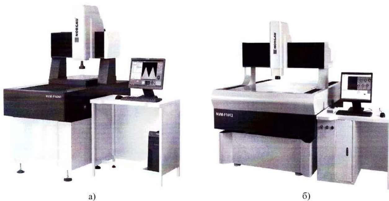
Рисунок 4 - Внешний вид систем модификации NVM-P а) с фиксированным порталом и б) с подвижным порталом
