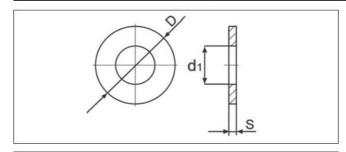
Применяется в машиностроении и приборостроении в качестве контрящего элемента соединения. Без покрытия, цинковое покрытие.
