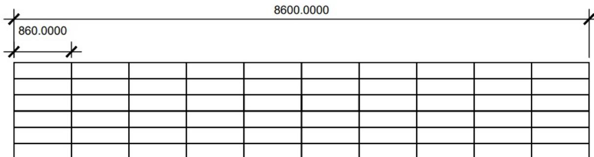
3) если система в длину состоит из 10 кабинетов размером 865 мм, общая длина системы составит  $865 \cdot 10 = 8650$  мм. Что не соответствует длине, согласно требованиям документации – «не менее 9000 мм».
