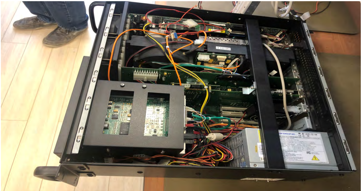
Рис. 3 Устройство термоконтроля (измеритель распределения температуры волоконно-оптический ПТС -1000)
