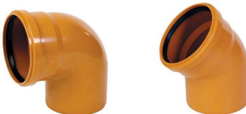
Отводы ПВХ для наружной безнапорной канализации выпускаются из поливинилхлорида или полипропилена оранжевого цвета, обладающего повышенной прочностью, гладкой внутренней поверхностью, обеспечивающей качественное прохождение сточных вод без налипания на стенках осадков и разного рода отложений, стойкостью к коррозии и агрессивным средам.
