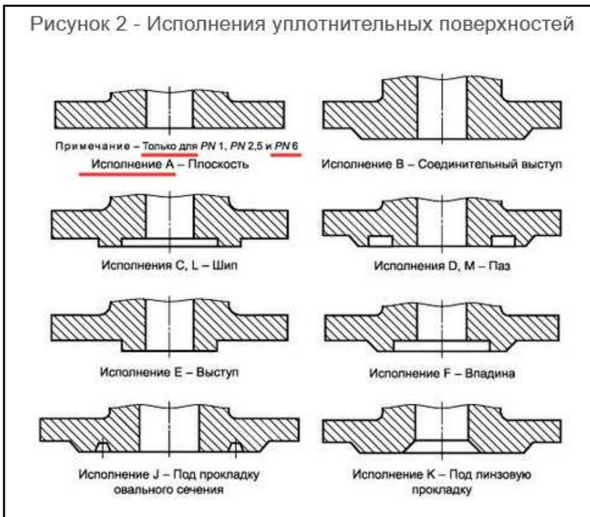
То есть, вариант «А» в параметре «Исполнение уплотнительной поверхности» используется только при номинальном давлении PN6, однако данное значение можно указать по Инструкции при других значениях параметра «Номинальное давление». Также в данном ГОСТ присутствуют другие **подобные «Исключения», которые Заказчик охотно использует в корыстных целях.**
